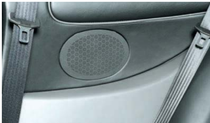
Versteckt: Der 25 cm große Neodym-Woofer im rechten hinteren Seitenteil ist dank Original-Optik nicht einmal zu erahnen; auf der anderen Seite sitzt sein baugleicher Partner.
